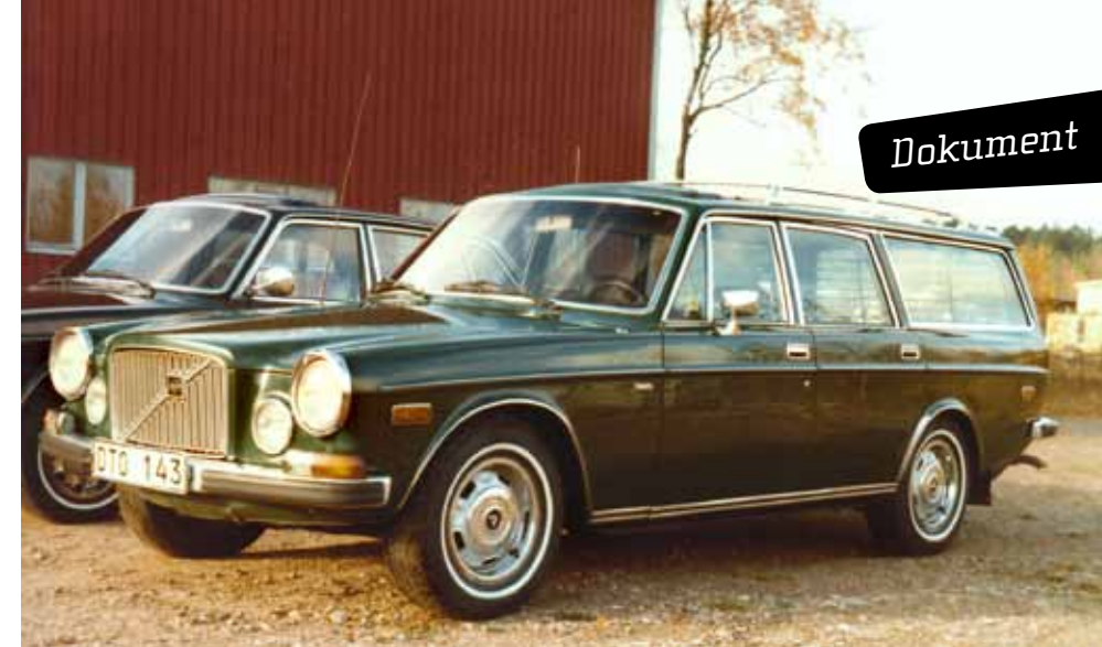
Under 1970-talet uppdaterade Sture Levin sin 165 i takt med Volvos årsmodellförändringar. Här har stötfångaren fram bytts till 1973 års utförande, även grillen är av senare modell. Bak fick den ett hemmasnickrat 165 GLE-emblem.
