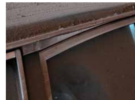
Inte ens ett tjockt lager damm kan dölja de speciella lister som Yngve Nilssons karosserifabrik tillverkade för Sture Levins 165. Överallt hittar man speciallösningar, på förarsidan satte Sture dit en inifrån justerbar backspegel från en BMW.
