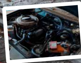
Den raka sexan är en B30F, en lågkompressionsvariant avsedd för den amerikanska marknaden.
