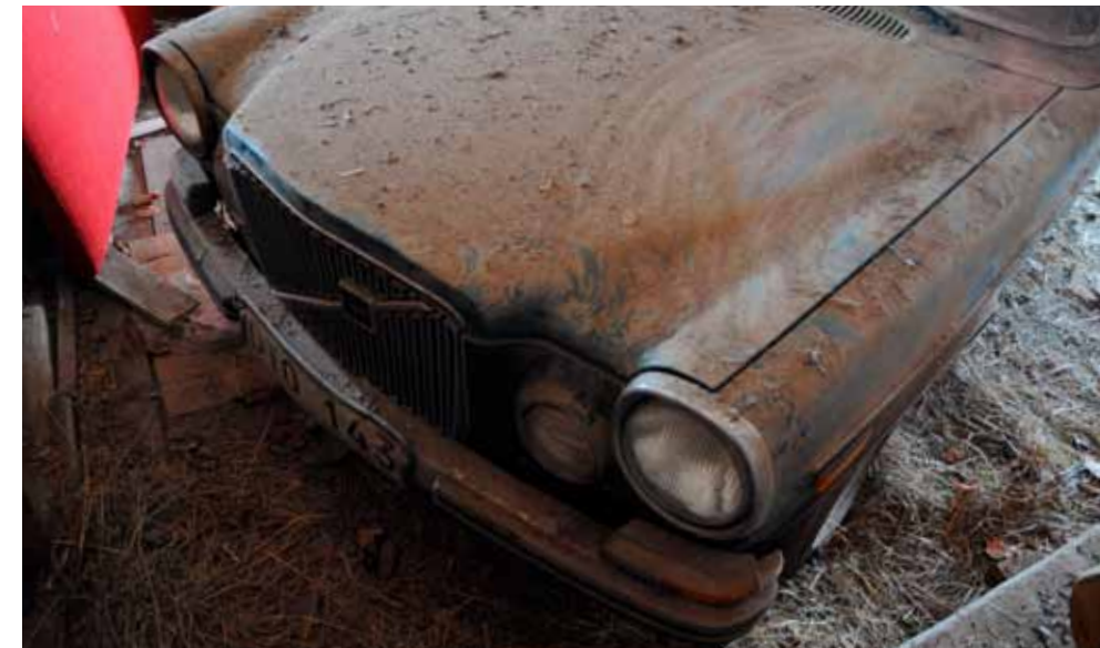
Inte ens ett tjockt lager damm kan dölja de speciella lister som Yngve Nilssons karosserifabrik tillverkade för Sture Levins 165. Överallt hittar man speciallösningar, på förarsidan satte Sture dit en inifrån justerbar backspegel från en BMW.
